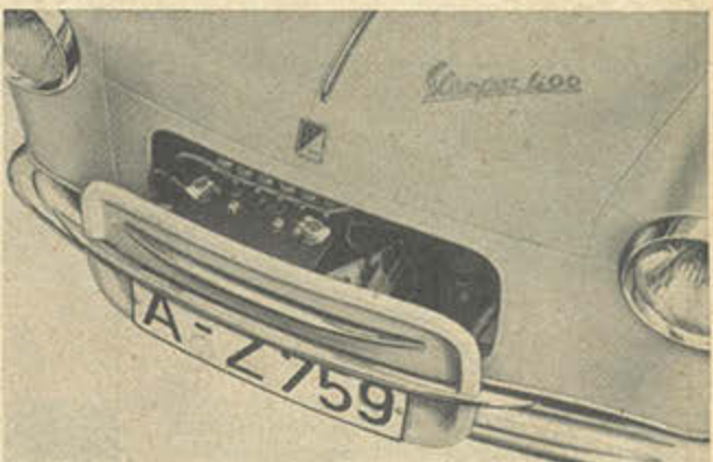
Unter dem Bug des VESPA 400 sind Batterie und Bremsölbehälter praktisch in einer Schublade angeordnet.
