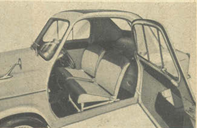
Die Türen haben Schiebe- und Ausstellfenster, sie sind wie die Sitze mit Kunstleder bezogen. Das Reservierad ist bequem unter dem rechten Sitz untergebracht.
