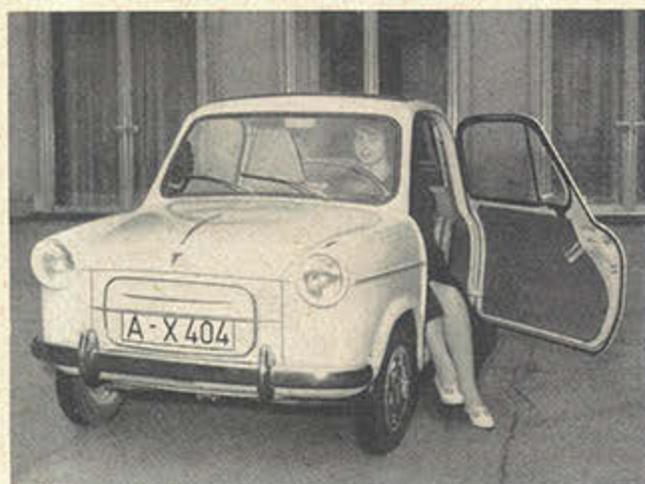
DER VESPA 400. Cabrio-Limousine. Großräumiger Kleinwagen mit allgemein beachtetem technischem Komfort. 2 Zylinder, Zweitakter, für 2 Personen, 14 PS, 400 ccm, 90 km/h. Benzin-Ölgemisch im Verhältnis 1:50 (1), 6 Jahre erprobt. Einzelradaufhängung. Preis DM 3285,- plus DM 205,- für Heizung und Zweitakt-Mischanlage. Asymmetrisches Abblendlicht.
