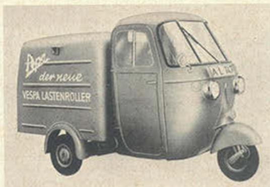
VESPA-LASTENROLLER „Ape“, der ideale Schnelltransporter für viele Zwecke. Mit Kasten, Pritsche, als Kipper und in anderen Ausführungen lieferbar. Preis von DM 2440,- bis DM 3370,-. Kleiner Steckbrief: 7 Zentner Nutzlast, 3 Ltr. Treibstoff-Normverbrauch/100 km, Geschwindigkeit 60 km/h. Die Ape ist durch ihre exklusive Form und günstigen Flächen, wie das Bild zeigt, auch ein guter Werbeträger.
