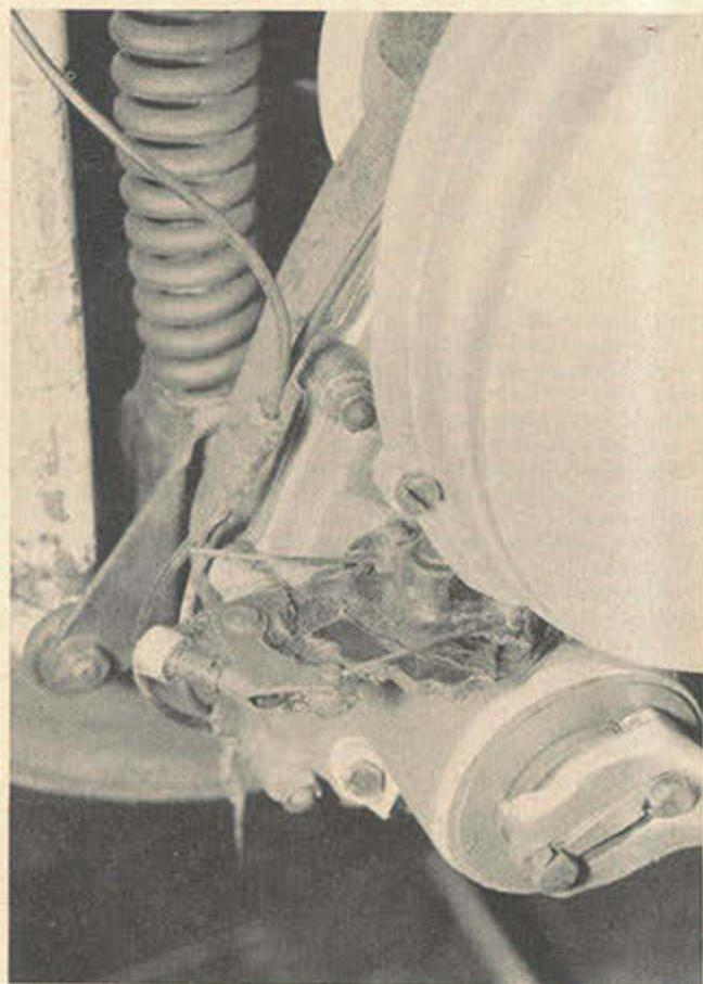
Bei Vespas mit Seilzugschaltung erfolgt die Grobeinstellung der Schaltung am Schaltsegment.
