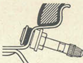
Das Ventil sitzt direkt in der Felge. Es hat keine Verbindung mit dem Reifen selbst.
