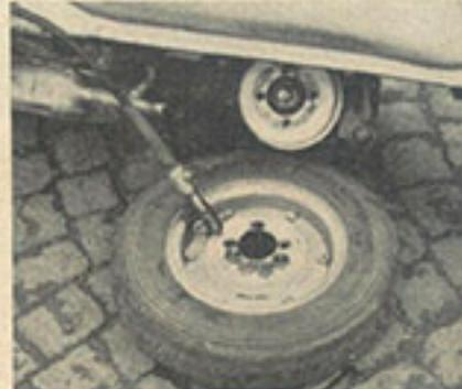
5 Im zweiten Arbeitsgang erfolgt das Demonstrieren der teilbaren Felgen, um den Schlauch herausnehmen zu können. Dazu wird das Rad so auf den Boden gelegt, daß die Felgenseite mit dem Ventil noch oben liegt.
