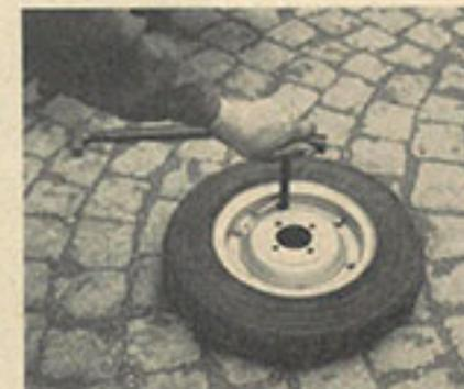
7 Nun können die Mutter der Felgenverschraubung gelöst werden, wozu ebenfalls wieder der T-förmige Schlüssel dient. Dem Abheben der einen Felgenhälfte steht nichts mehr im Wege und Schlauch und Reifendecke sind so ausgebaut.
