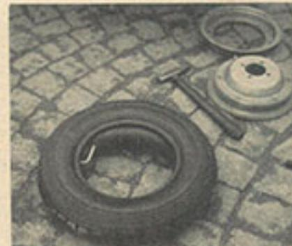
8 Der geflickte oder neue Schlauch wird leicht vorgepumpt und in die Reifendecke eingelegt. Wenn man es gerade zur Hand hat, empfiehlt es sich, in die Reifendecke etwas Talkum oder Federweiß einzustreuen. Auf jeden Fall ist darauf zu achten, daß der Schlauch faltenlos in der Decke liegt.
