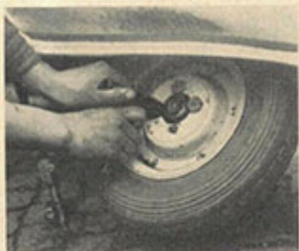
3 Als nächste Arbeit folgt das Lösen der Radmutter, das mit dem T-förmigen Schlüssel, der auch zugleich Zündkerzen-Schlüssel ist, aus dem Bordwerkzeug erfolgt. Die gelösten Mutter legt man möglichst nicht in den Sand oder Straßenschmutz, da sonst beim Wiederaufschrauben leicht das Gewinde beschädigt wird.
