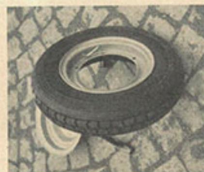
9 Beim Zusammenbau wird der Reifen zuerst in die Felgenseite mit der Ventilöffnung eingelegt.
