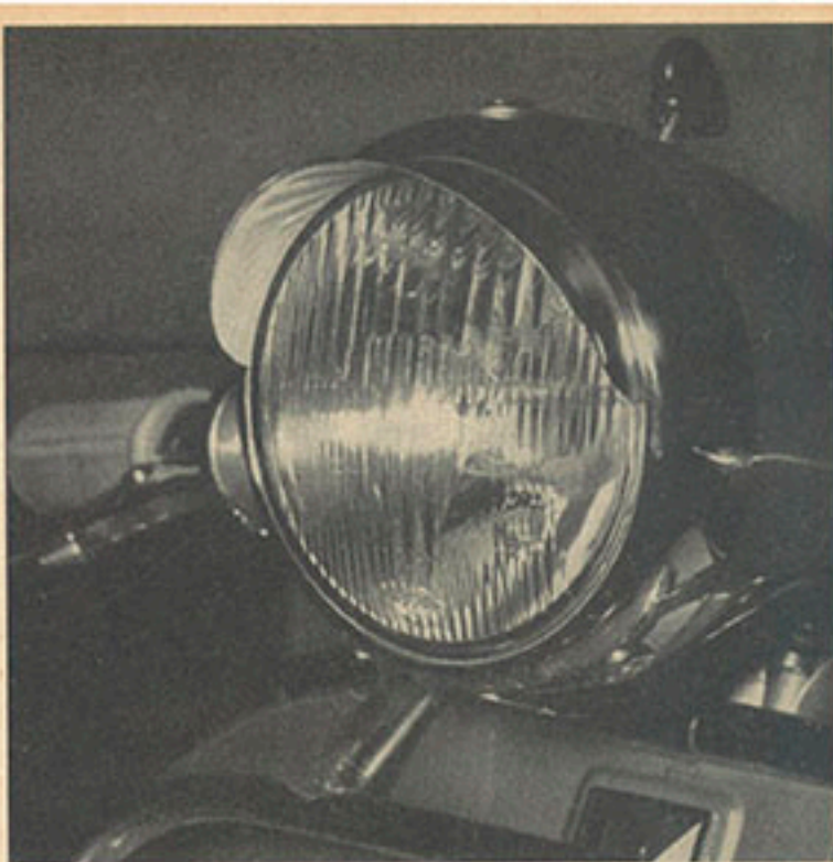
Durch seine starre Befestigung am Lenker sind beim Vespa-Scheinwerfer große Einstellfehler unmöglich. Die kleine Blendkappe erweist sich besonders bei Regen und Nebelfahrten besonders wertvoll.
