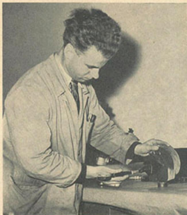
Hier wird gerade eine Zylinderlaufbahn geprüft. Das Meßgerät weist auf ein Tausendstel genau
