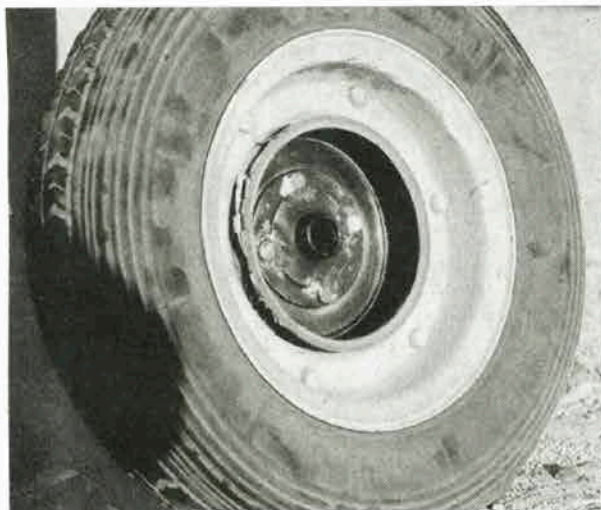
Eine Bremstrommel noch in der Felge verschraubt.
