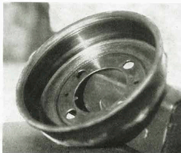
Diese Bremstrommel hat schon erhebliche Riefen, sie wäre aber durch Ausdrehen noch zu retten. Das beste ist aber in solchen Fällen immer eine neue Bremstrommel.
