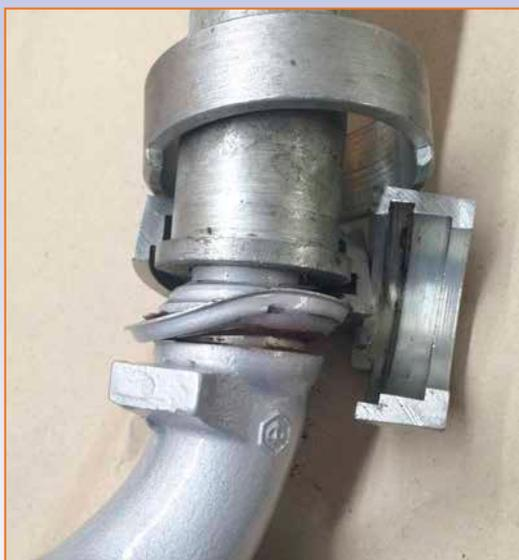
Die neue Schale wird mit dem Rohr mit leichten Schlägen in Position gebracht. Die Masse des Rohrs reicht aus, es wird kein zusätzlicher Hammer benötigt.
