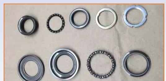
Wenn ein Lenkrohr lackiert werden soll, dann für Strahlen und Lackieren immer die alte Schale auf dem Lenkrohr lassen. Der Lagersitz wird so gut geschützt.
