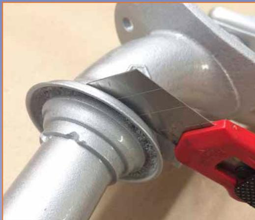
Mit dem Abzieher wird an dem Staubschutzring gezogen:
