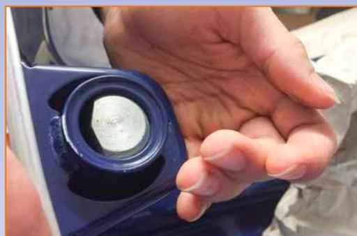
Das Werkzeug ist ausgeschnitten, damit für die Demontage nicht das Lenkschloss ausgebaut werden muss. Achtung: Die Lagerschale fliegt nach nur zwei bis drei Schlägen ab – und das im wahrsten Sinne des Wortes. Unbedingt mit der Hand – oder einem Lappen – die Lagerschale sichern, damit sie beim Aufschlagen keine Macke im neuen Lack produziert.
