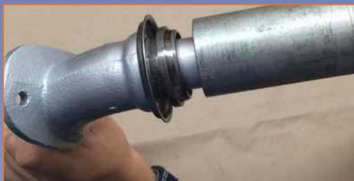
Auch das obere Lenkkopflager am Rahmen sollte freigeschnitten werden, damit der neue Lack nicht ungewollt beschädigt wird:
