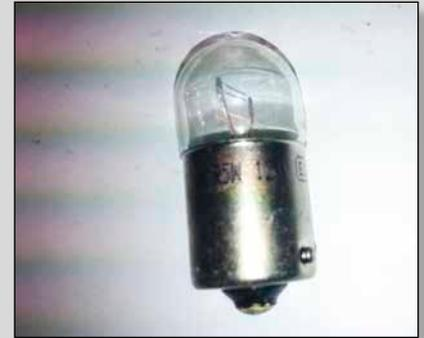
Der zweite wichtige Punkt ist das Leistungsmerkmal der Birne, die „Watt-Zahl“. Auch hier muss penibel darauf geachtet werden, dass der richtige Wert gewählt wird. Zum einen definiert der Wert, wie hell die Birne leuchten wird, zum anderen darf man das Leistungsvermögen der Lichtmaschine nicht außer Acht lassen. Daher ist zu empfehlen, dass man sich via Handbuch, lokalem Vespa-Händler, GSF o.Ä. informiert, welche Birne wo im eigenen Fahrzeug verbaut sein soll.
