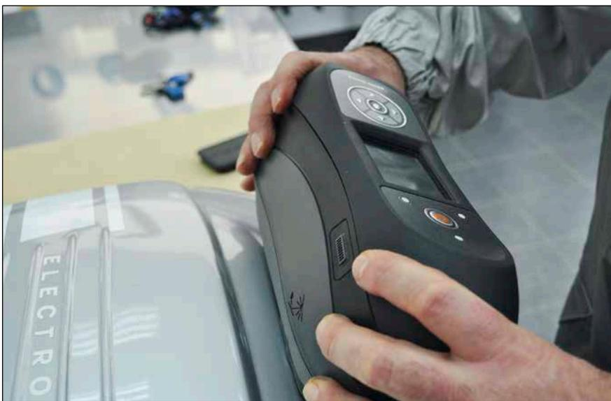
Mit einem Spezial-Scanner können die passenden Farben direkt von den noch vorhandenen Karosserieteilen erfasst werden. Der Computer berechnet daraus die erforderlichen Komponenten für den Reparaturlack.
