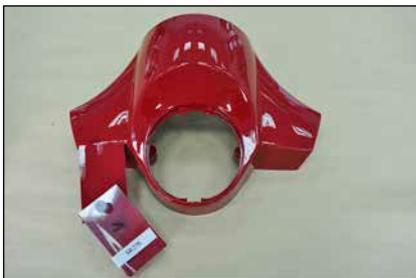
Mittels Farbtonpaspeln kann man sich bei der Suche nach dem passenden Reparatur-Farbton ebenfalls an die neue Lack-Mischformel annähern.
