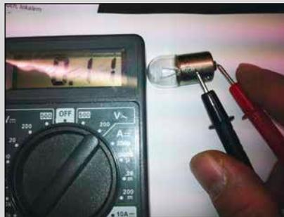
Wir messen den Widerstand des Leuchtmittels. Eine funktionierende Birne hat nur einen Widerstand von wenigen (eigentlich gar keinen) Ohm. Eine defekte Birne hat keinen Durchgang, also einen „unendlichen“ Widerstand, der auf den meisten Geräten mit „1“ oder „-1“ angezeigt wird.
