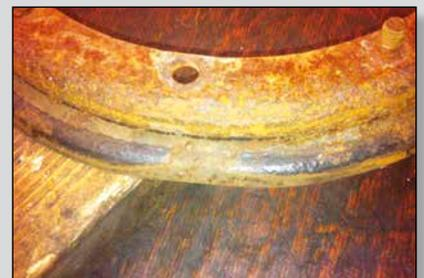
gehört nicht mehr an den Roller, sondern in die Altmetall-Tonne. Dellen in einer Felge stören den Rundlauf und erzeugen Vibrationen. Starker Rost innerhalb einer Felge scheuert den Schlauch kaputt.
