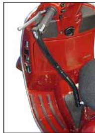
die Sitzbank geschraubt, eine spezielle diebstahlsichere Kette fixiert das Fahrzeug bei eingeschlagenem Lenker. Hierfür wird eine klemmbare Aufnahme (ähnlich wie bei Lenkungsdämpfer) in das Lenkerende montiert. Wird das Schloss nicht benötigt, wird die Kette im Fußraum unter der Sitzbank praktisch verstaut. Das Sicherheitsschloß gibt es für alle Vespa-Klassikmodelle. Die Kosten liegen bei rund 74 Euro.
