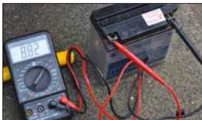
Ganz wichtig: Die Batterie nach dem langen Stehen überprüfen. Lässt die Spannung nach, sollte mittels destilliertem Wasser und Aufladegerät nachgeholfen werden. Oder gleich eine neue einbauen.
