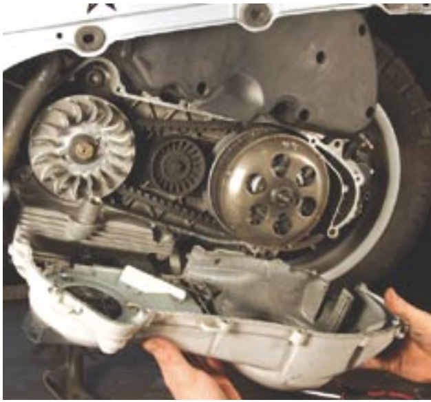
Bild 1: Der abgeschraubte Deckel gibt den Blick auf die Variomatik frei. Foto: Moritz Kohrs
