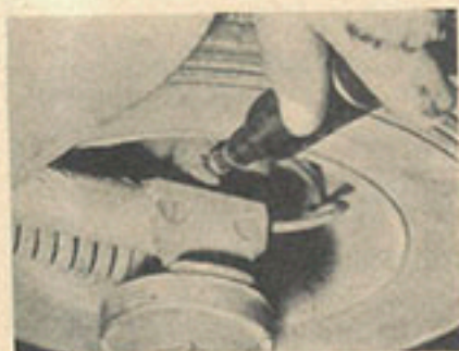
Abb. links: Mit der Fettpresse wird das Fett in die Schmiernippel gedrückt. Selbstverständlich mocht man den Schmiernippel sauber, bevor man die Fettpresse ansetzt. — Abb. mitte: Bei der neuen Vespa T 56 gibt es 3 Schmiernippel, die am Vorderrad liegen. 2 dienen zur Fettversorgung der Federung, der 3. liegt am Tacho-Antrieb. — Abb. rechts: Bei älteren Vespa-Modellen wird der Tacho noch vom Hinterrad aus angetrieben, auch er hat einen Schmiernippel.
