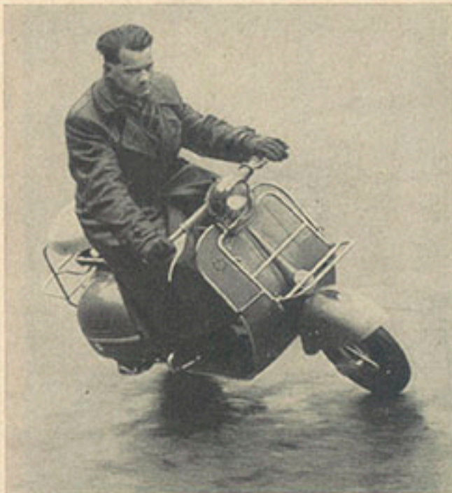
Hier wird eine Vespa auf regennasser Straße durch die engen Kurven des Kesselbergs gefahren. Trotz der starken Schräglage zeichnet sich die Vespa durch einwandfreie Spurhaltung aus.
