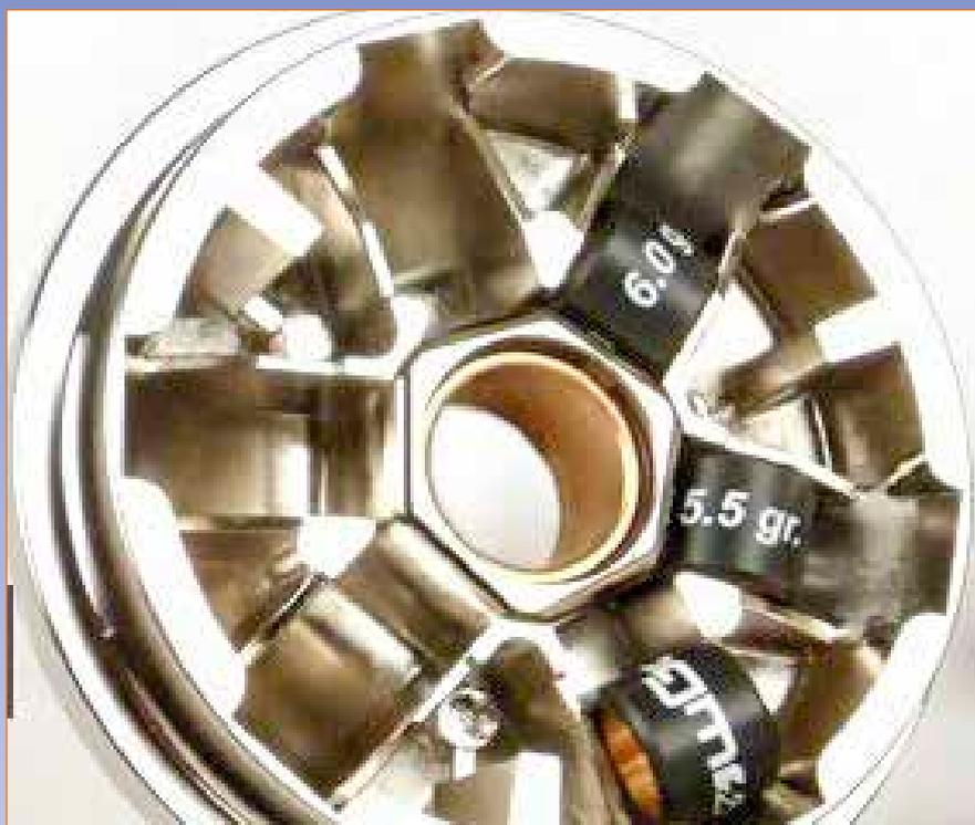
Diese Gewichte haben immer eine Rollenform und können sich in der Riemenscheibe von innen nach außen bewegen. Je mehr die Scheibe – und damit die Gewichte – beschleunigt werden, umso weiter werden sie durch die Fliehkraft nach außen getrieben. Durch das zusätzliche Gewicht an der äußeren Kante der Riemenscheibe wird diese näher an die andere Scheibe gedrückt. Der Riemen kann nicht mehr ganz innen laufen und wird in der Laufbahn nach oben verschoben.
