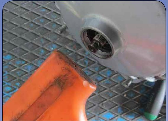
ACHTUNG: Ehe die Bremsscheibe von der Trommel geschraubt werden kann, müssen die entsprechenden Schrauben erwärmt werden:
