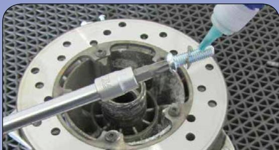
Die Schrauben mit Drehmomentschlüssel festziehen (Nm-Wert je nach Modell 6-12):
