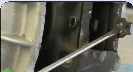
Das Abriebmaterial hat im Neuzustand eine Stärke von 3 mm. Piaggio gibt die Verschleißgrenze mit 1,5 mm an. Auf der Bremsscheibe ist die Verschleißgrenze aufgedruckt:
