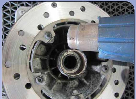
Die Schrauben sind eingeklebt. Ohne Erwärmen ist die Gefahr groß, dass der Schraubenkopf abreißt. Nicht gut ...
