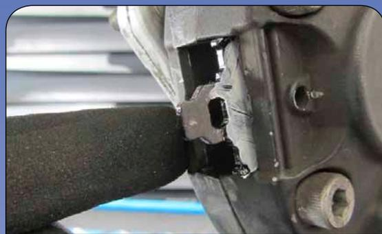
Sicherungsstift hineinschieben und Einbau-richtung des Federstahls beachten!
