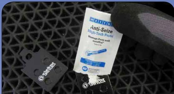
Dann die Beläge außen gegeneinander reiben, bis beide Beläge vollflächig mit der Paste eingerieben sind
