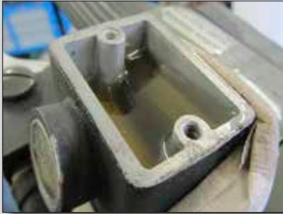
Es empfiehlt sich, einen Lappen um den offenen Ausgleichsbehälter zu legen, damit eventuell überlaufende Bremsflüssigkeit nicht auf den Lack gelangt. Bremsflüssigkeit, die auf den Lack getropft ist, am besten sofort mit Bremsenreiniger abwaschen.
