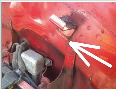
Zwischen Feder und Blech muss Strom fließen können, also müssen beide Teile an der Kontaktstelle von Lack befreit werden. Ach hier neigt das blanke Metall natürlich zum Korrodieren. Ein kurzes Wegschleifen des Rosts mit feinem Schleifpapier ist zu empfehlen.
