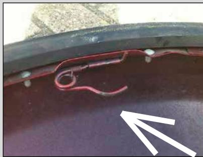
wird in das entsprechende Blech am Roller eingeklinkt:
